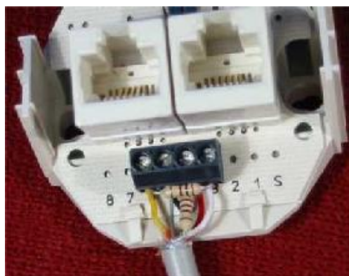
Angeschlossene Dose mit Abschlusswiderständen
