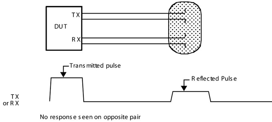
**FIGURE 3. Open Circuit**
