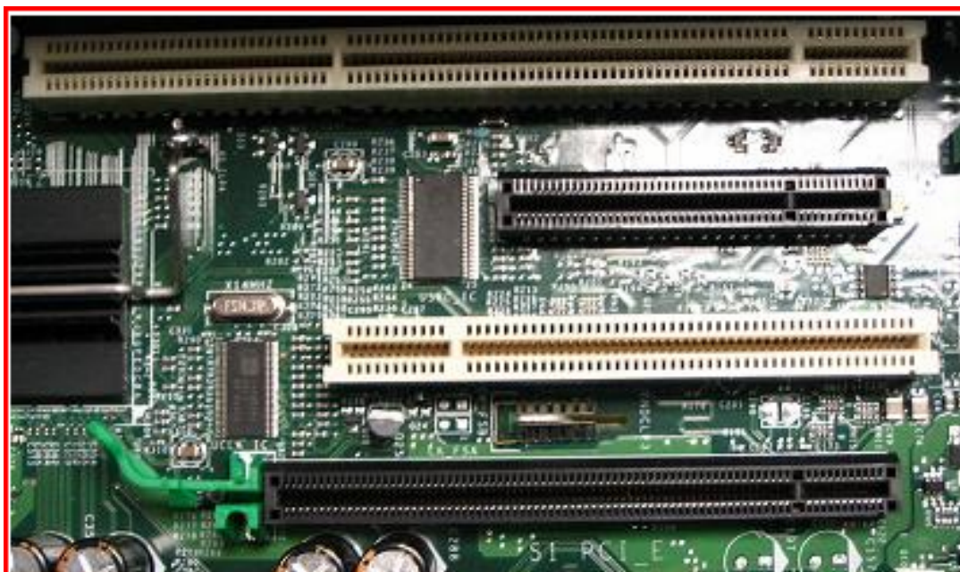
Bild: Platine mit PCI-Bus Steckplätzen (Slots)
