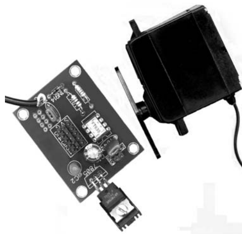
Bild 7.14: Testplatine für den FT639 mit Servo
